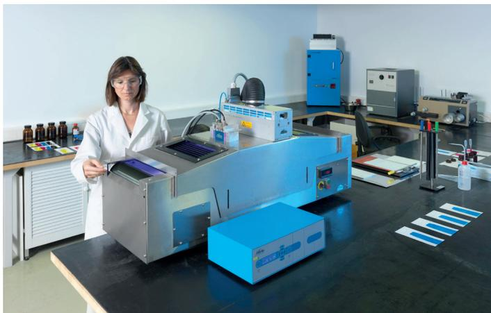
Zur Sicherung höchster Qualität werden alle UV-Strahler in Bestrahlungskammern oder eigens eingerichteten Dunkelräumen vermessen, bevor sie unser Haus verlassen.
